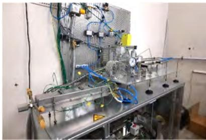
*Aufbau der Wasserstoffhochdruckbeladungsanlage, wie sie gegenwärtig am WWI zur Verfügung steht. Im unteren Teil befindet sich der Kompressor. Im Vordergrund ist die Beladungskammer mit der Heiz- und Kühlvorrichtung zu sehen.*
