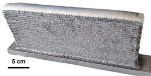
WAAM gefertigte Schweißwand aus einer sekundären Aluminiumlegierung.
